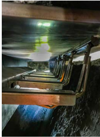
Yeni sekonder bant sıyırıcı, bakım ve konveyör duruşlarını en aza indirecek şekilde tasarlanmıştır
