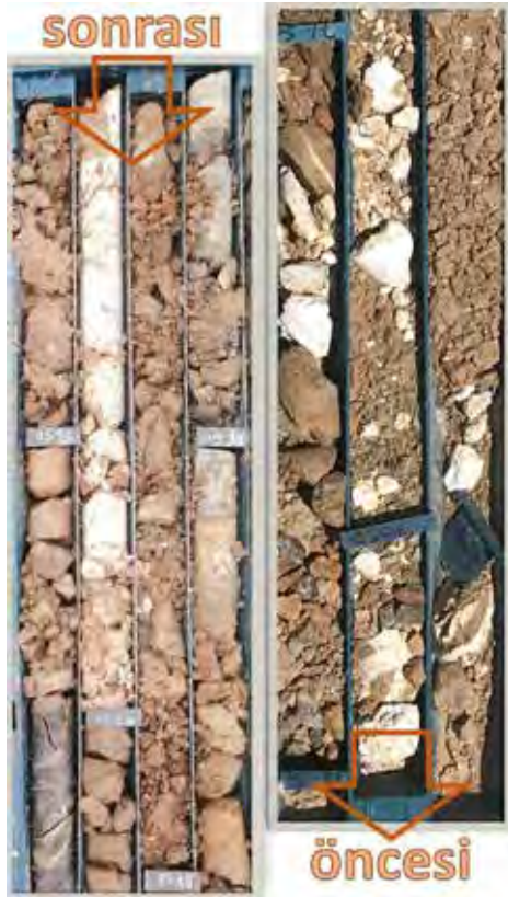
Görsel 1. Karot kalitesinin ve karot veriminin düşük olduğu bir sondaj çalışması ve sonrasında parametrelerin iyi bir disiplin altında uygulanması sonucu karot veriminin ve kalitesinin yükselmesi
