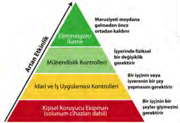
© 2022 Martin Engineering Kontrol hiyerarşisi - N2 ile uzaktan izleme, maruz kalma meydana gelmeden önce ortadan kaldırarak optimum risk kontrolü sağlar
