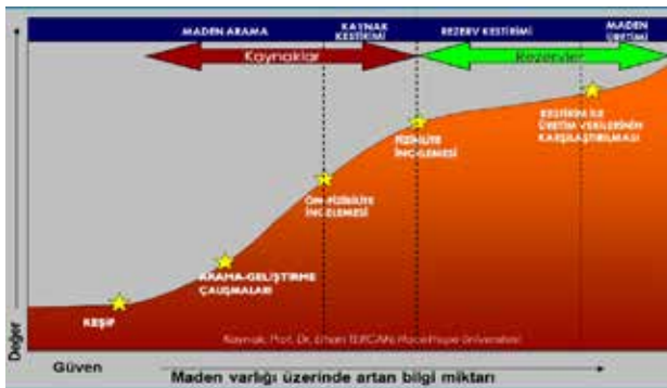
Şekil 3: Maden varlığı bilgisi düzeyi ile proje aşamaları (TERCAN, 2015)
