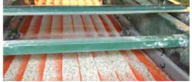
Döküm Kumunun Polyweb® DU Poliüretan Panel ile Sınıflandırılması
