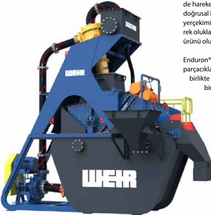
Weir Minerals kum yıkama tesisi
