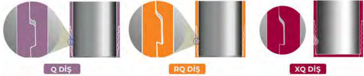
Şekil 1."Q", "RQ" ve "XQ" dişlerinin profilini göstermektedir. Dişlerin kanatları gerilim yükünü taşıy - yükü taşıyan kenar "basınç kanadı" olarak adlandırılır.
