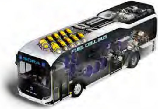
Şekil 6. Hidrojen Yakıt Hücre Teknolojisi ile Toyota tarafından geliştirilmiş ağır vasıta versiyonu bir otobüs (Toyota, 2024b) 15
