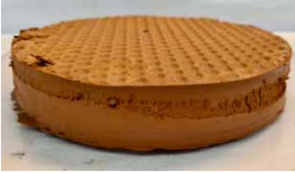
Resim 6: Altın tesisi filtrelenmiş atığı
