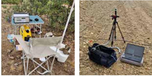
Şekil 2. CSRMT verici birim ve jeneratör (üstte). Manyetik ve elektrik alan algılayıcıları (altta).
