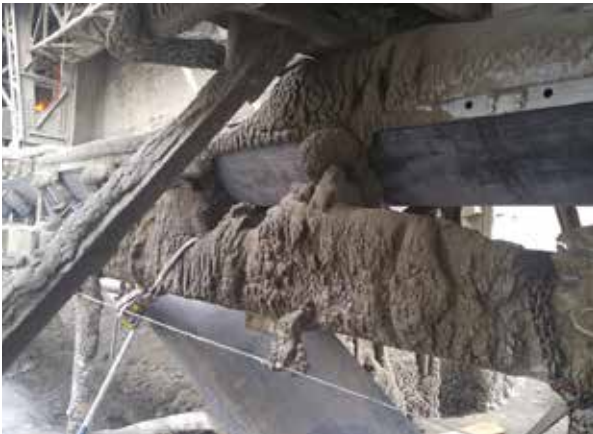
Yetersiz temizlikten kaynaklanan geri taşınım, tüm sistem boyunca bileşenleri ve güvenliği etkiler.
